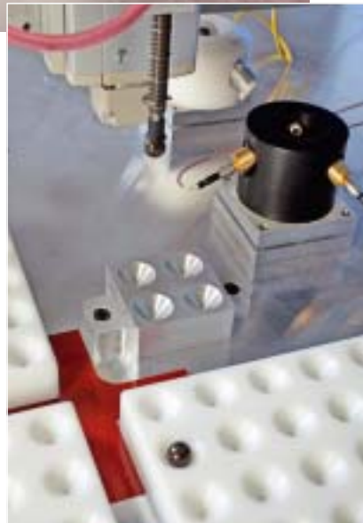
Vibrant Automated Ceramic Ball Tester zur PCRT-Prüfung von Siliziumnitridkugeln für Hochleistungseinsätze in Turbinenkugellagern
