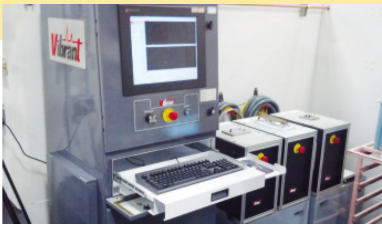
Bild 2 PCRT-Testsystem zur Übertemperaturprüfung von Turbinenschaufeln.
